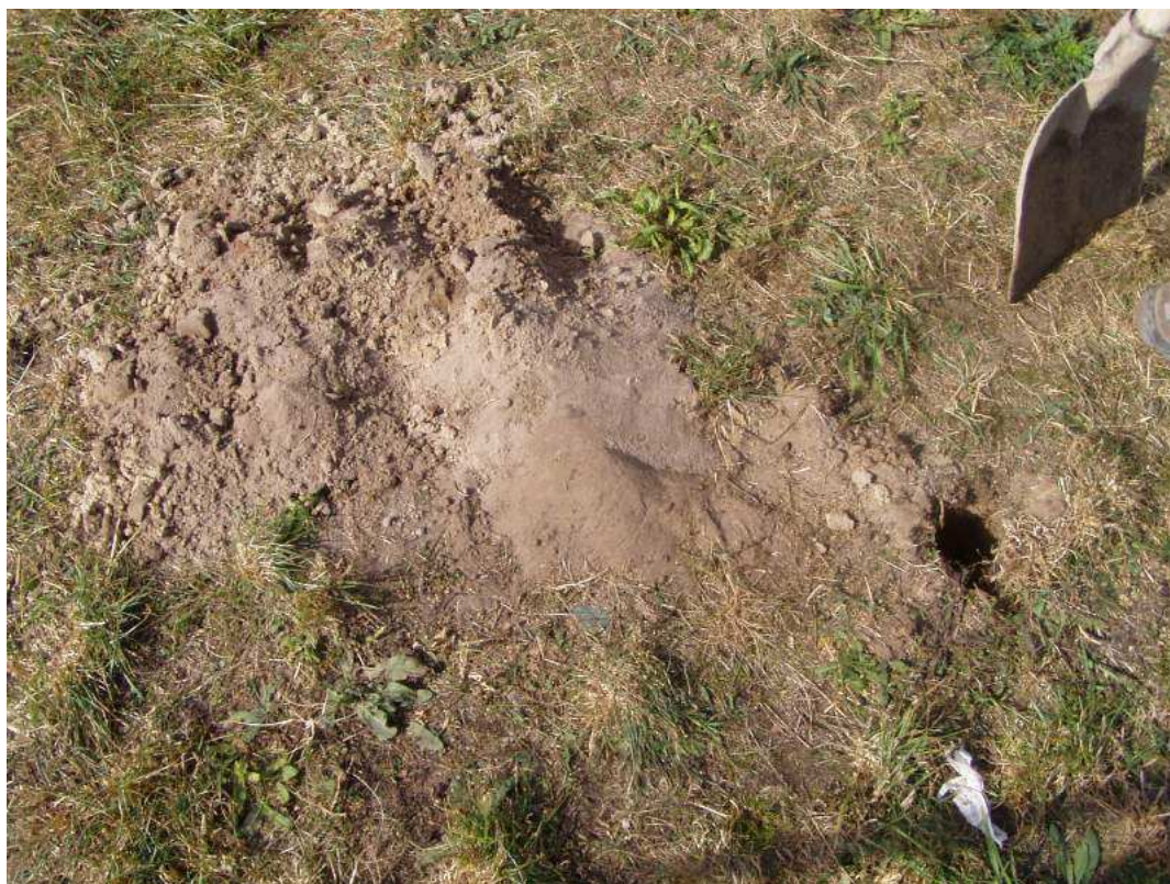
Wykonywanie odwiertów (nr 7) Piasek gr. 100cm
