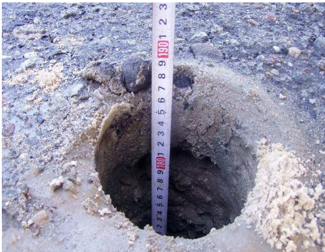
Wykonywanie odwiertów do głębokości 183cm p.p.t
